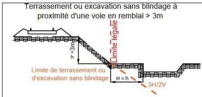
**Nota** : les remblais de plus de 3 mètres de hauteur (h) bénéficient d'une double protection :
